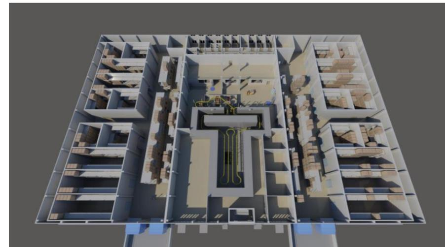
**компоновка зон центра облучения на базе гамма-установки**
